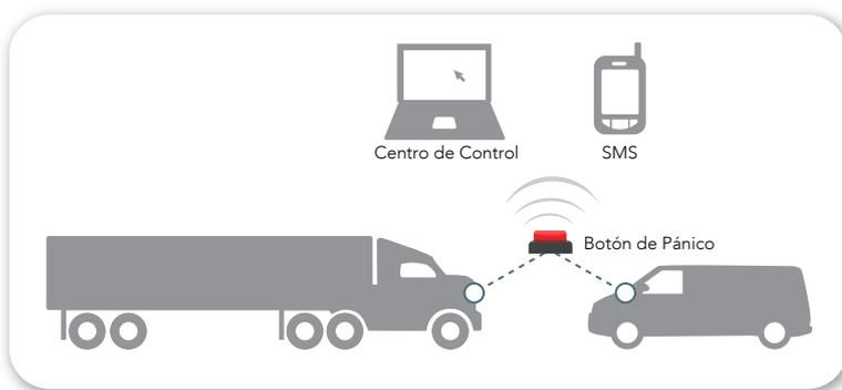
Esta herramienta permite que el conductor, de forma disimulada gracias a su instalación totalmente oculta, emita una alarma de pánico a su Centro de Control o que se envíe un SMS al teléfono de emergencia que se determine. De esta forma, la empresa puede levantar la operativa que se considere adecuada para solucionar la incidencia o problema.
